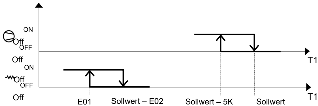
Abbildung 10: Schalttdiagramm besondere Betriebsweise E-Heizstab
