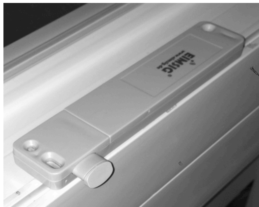
B) Stößel umgedreht nach unten (mehr Infos siehe Anleitung des Fenstersensors)
