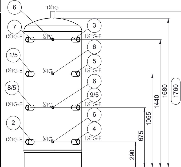
IG...Innengewinde, E... für E-Heizstab geeignet
