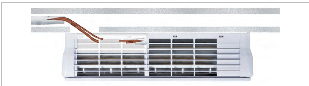
Abb. 24: Unterputzinstallation der Kältemittelleitungen (Ansicht von oben)
