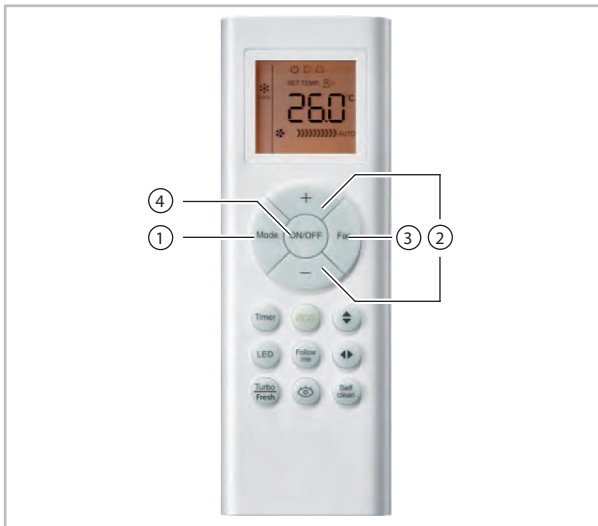
Abb. 10: Modus "Kühlen", "Heizen" und "Umluft"
